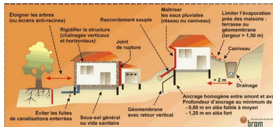
Exemples de dispositions à mettre en œuvre au sein des zones impactées par le risque de retrait-gonflement des sols argileux – Source : BRGM
