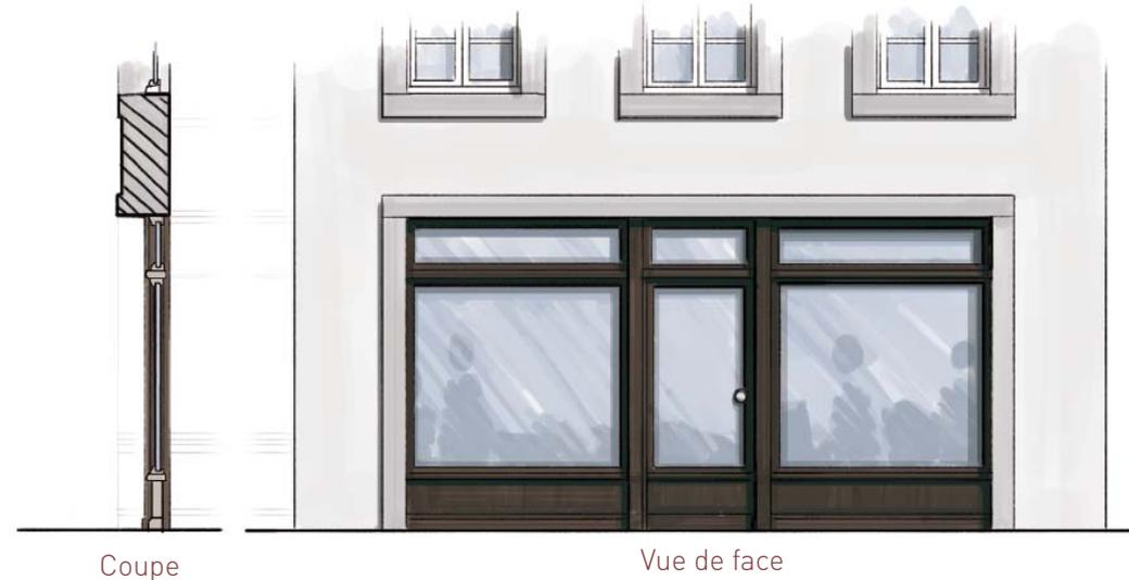
Les vitrines en feuillure sont caractérisées par un positionnement dans l'épaisseur des murs de la façade (comme des fenêtres). Il faut respecter ce retrait de la vitrine (20 à 25 cm). Les percements des vitrines répondent en général à la composition déjà existante des percements des étages (fenêtres), même si leur taille est différente. Quand le bâtiment comprend une porte extérieure d'accès aux étages, elle doit être différenciée du commerce.
